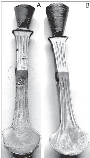
55 pav. Nortikėnų kovos kirvio LNM AR 486:1 eksperimentinis liejimas (plg. lent. 8) cire perdue (liejinys 2 (2.2)). Dėl nepakankamos temperatūros, kirvio ašmenys nebuvo pilnai išlieti. Taip pat matomas korėtumas palei skylę kotui. M. Wirth nuotr.
