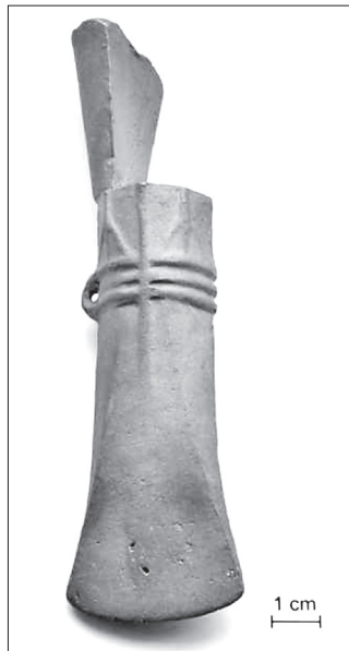
65 pav. Kirvio LNM AR 107:4 eksperimentinis liejimas (plg. 12 lent.) molinėje liejimo formoje (liejiny 3 (3.2)). Liejiny geros kokybės. M. Wirth nuotr.
