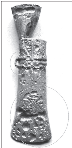
64 pav. Kirvio LNM AR 107:4 eksperimentinis liejimas (plg. 12 lent.) molinėje liejimo formoje (liejiny 3 (3.3)). Kadangi liejimo forma nebuvo pakankamai įkaitinta, dirbinio paviršius korėtas, o ašelė nepilnai išlieta. M. Wirth nuotr.
