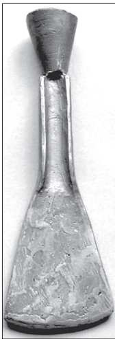
44 pav. Klaipėdos tipo kirvio LNM AR 107:1 eksperimentinis liejimas (plg. 7 lent.) molinėje formoje (liejinys 3 (1.3)). Liejinys kokybiškas. M. Wirth nuotr.
